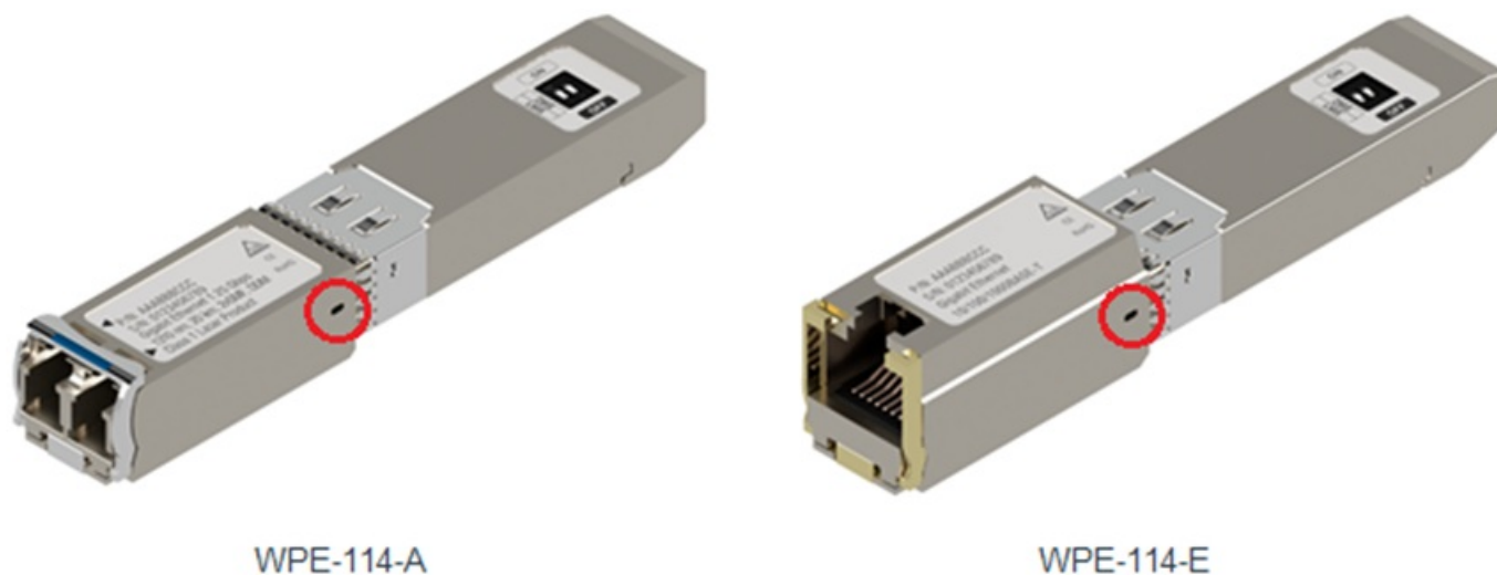
Рисунок 24 — Расположение светодиодного индикатора на боковой части зондов WPE-114-A и WPE-114-E
