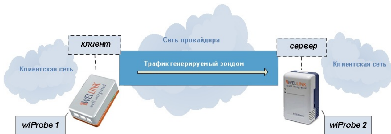
Рисунок 29 - Нагрузочное тестирование Out-Of-Service
