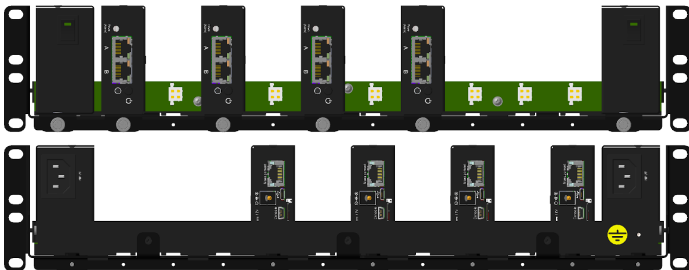
Рисунок 38 — Установка приборов в полку-шасси
