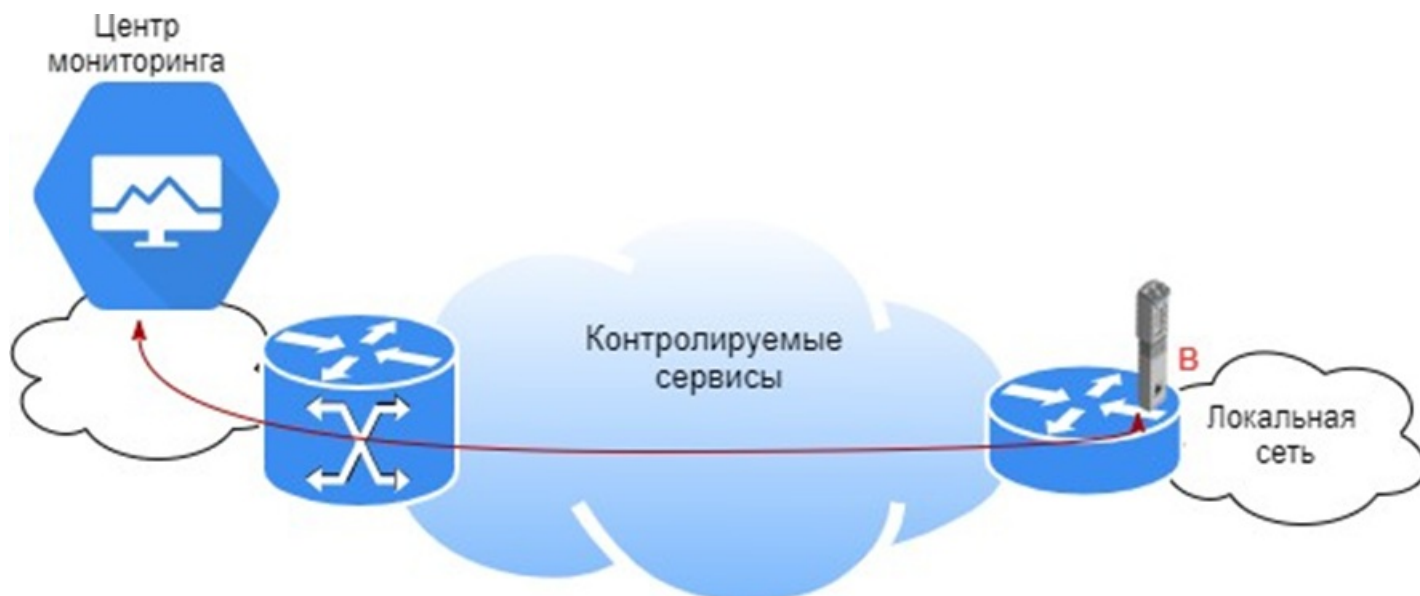
Рисунок 61 — Подключение в «разрыв»
