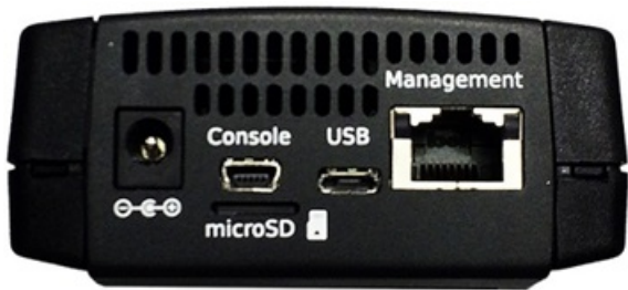
Рисунок 9 — Задняя панель зонда WPE-110-A
