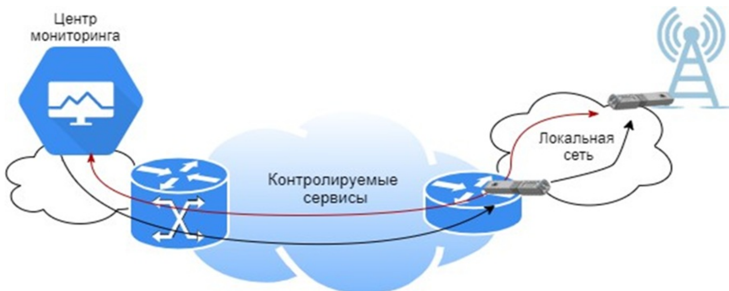
Рисунок 62 — Подключение в «свободный порт»
