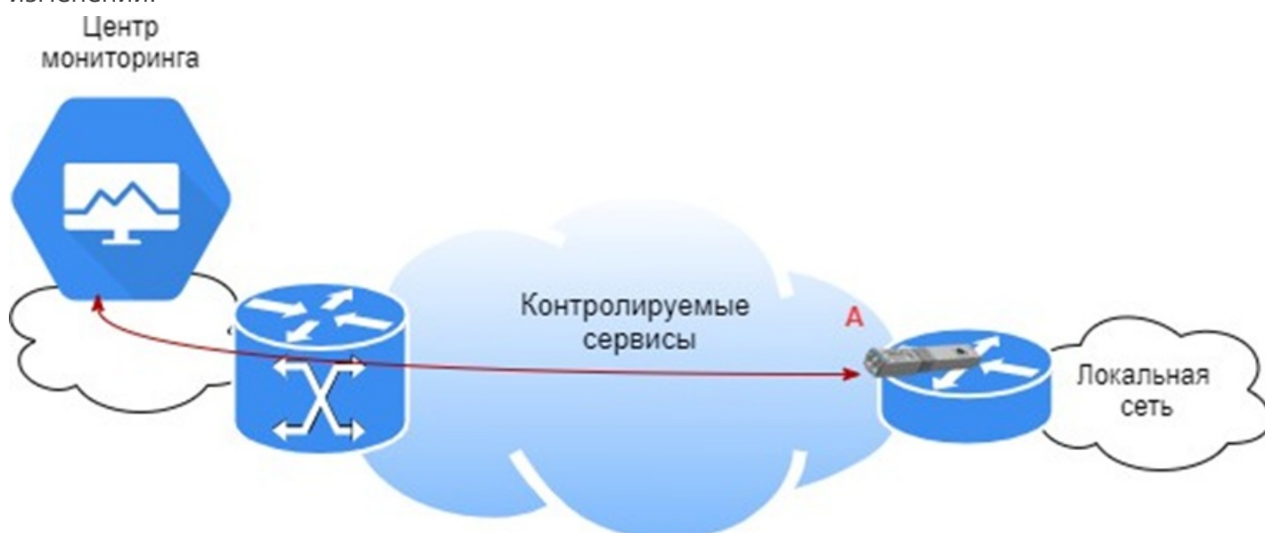
Рисунок 60 — Подключение в «разрыв»
