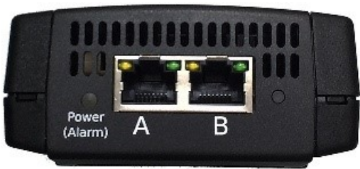
Рисунок 5 — Лицевая панель зонда WPE-110-A
