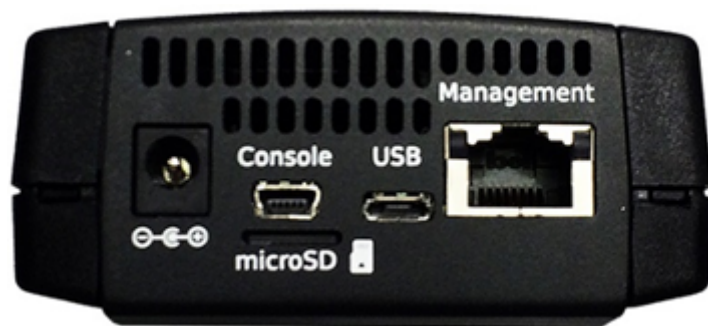
Рисунок 9 — Задняя панель зонда WPE-110-A
