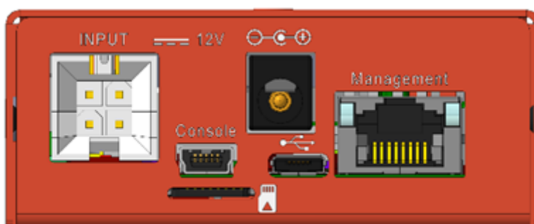
Рисунок 10 — Задняя панель зонда WPE-110-B
