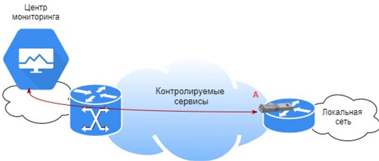
Рисунок 60 — Подключение в «разрыв»
